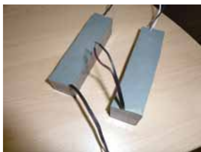
Рис. 5 Пример использования Dow Corning Sylgard 160 для заливки драйвера
